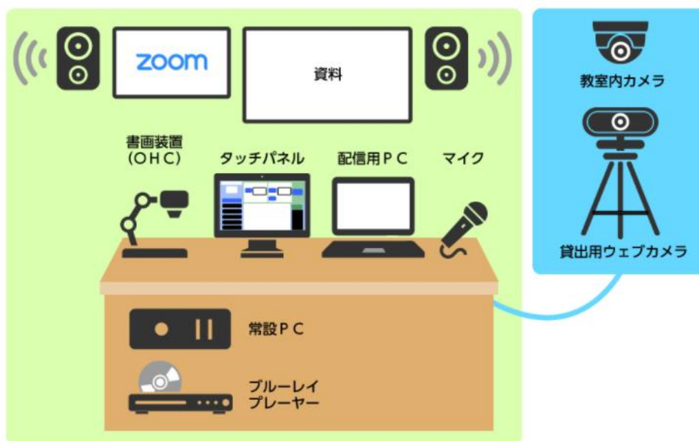
図 3：ミックス型授業用機器構成概要(教卓型)
