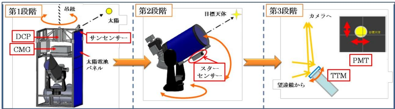
Fig. 2. 3段階姿勢制御・追尾システム。
